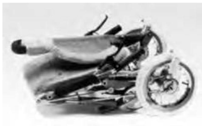
تصویر ۱۷- بالا: صندلی چرخ‌دار معلولین که با کمک انتقال نیرو با اهرم‌های دستی حرکت می‌کند. پایین: همان صندلی در حالت بسته و جمع شده
