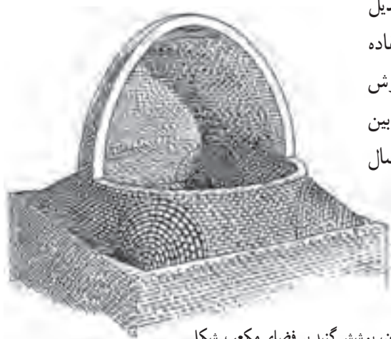
تصویر شماره ۳-۲۲ - ارمان ایران به جهان، پوشش گنبد بر فضای مکعب شکل
