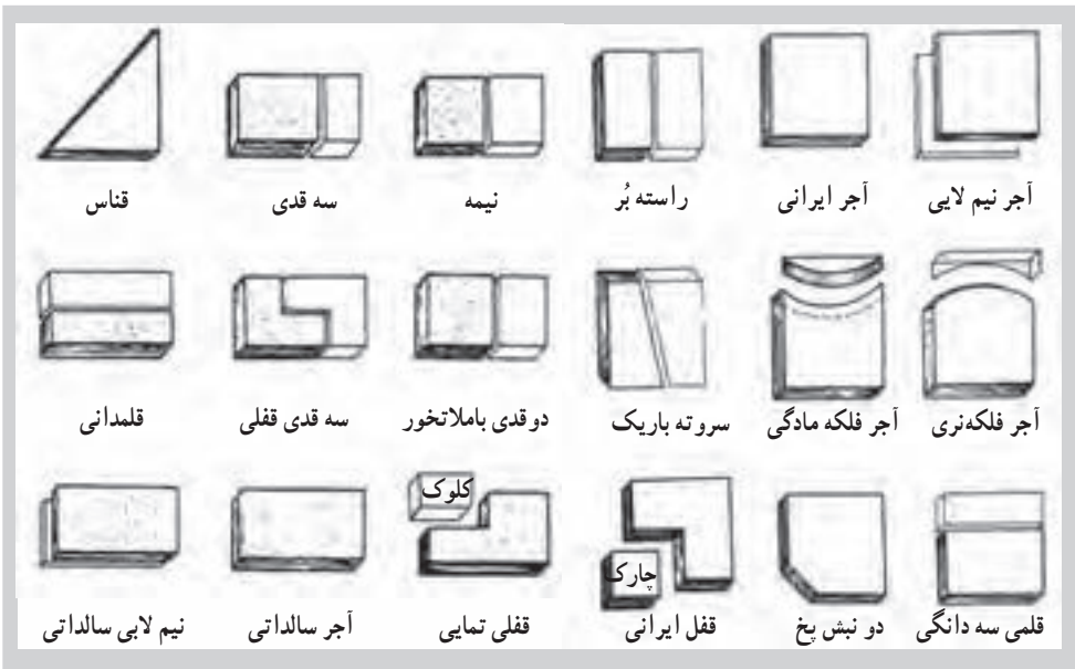
۱۳-۶- اجزای آجر و انواع تراش‌های روی آن
