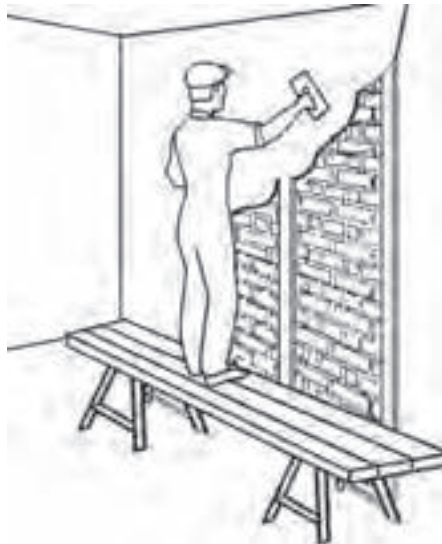
شکل ۵-۸- طریقه‌ی گچ کاری دیوار
