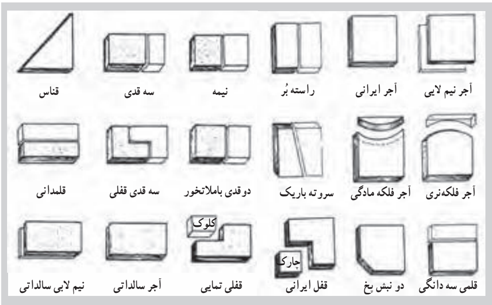
۱۳-۶- اجزای آجر و انواع تراش‌های روی آن
