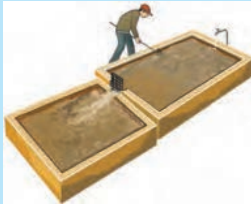
تهیه‌ی آهک شکفته به روش تر (دوغابی)
