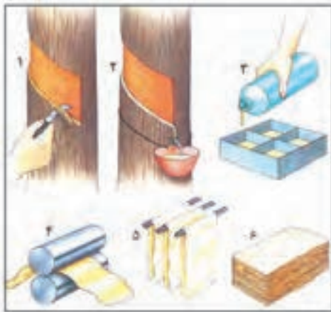
شکل ۱۴-۱- نحوه‌ی تهیه لاستیک طبیعی
