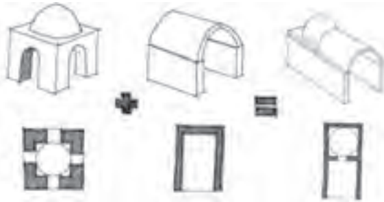
تصویر شماره ۱۲-۳. مراحل شکل‌گیری مساجد چهار تاقی به صورت شماتیک
