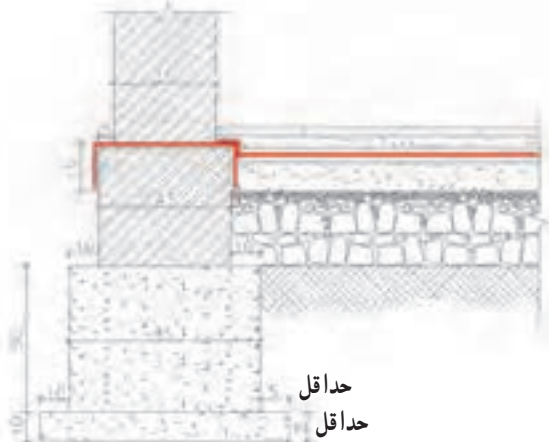
شکل ۶-۶- عایق کف بایستی کاملاً با عایق کاری دیوار و کرسی چینی متصل و یکپارچه باشد.
