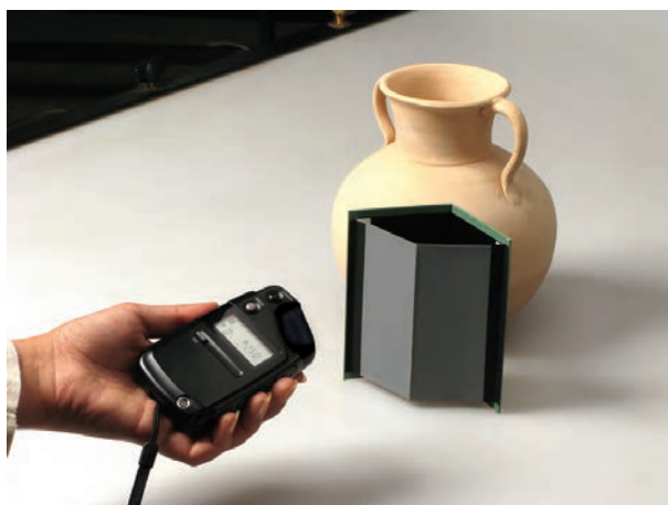
تصویر ۷-۹- نورسنجی بازتابی از کارت خاکستری
