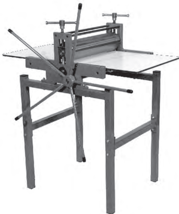
ب) پرس سیلندری مخصوص کالکوگرافی
