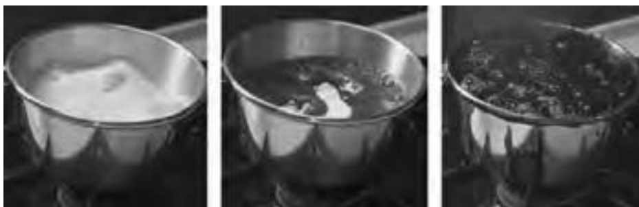
شکل ۱-ج) شکر در اثر گرما تجزیه می‌شود و به رنگ قهوه‌ای در می‌آید. اگر گرما را ادامه دهیم شکر بیشتر تجزیه شده و جامد سیاه رنگی برجای می‌ماند.
