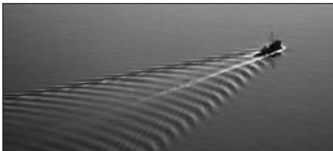
تشکیل امواج بر اثر حرکت شناور
