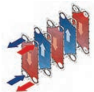
نحوه قرارگیری صفحات در مبدل صفحه‌ای
