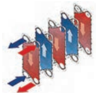
نحوه قرارگیری صفحات در مبدل صفحه‌ای
