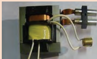
شکل ۱۱- ساختمان ترانسفورماتور هویه تفنگی
