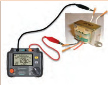
شکل ۹- کاربرد میگر در اندازه‌گیری مقاومت عایقی
