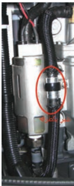
پمپ فشار پایین به همراه شیر یک‌طرفه
