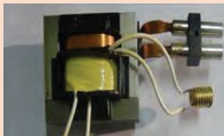
شکل ۱۱- ساختمان ترانسفورماتور هویه تفنگی
