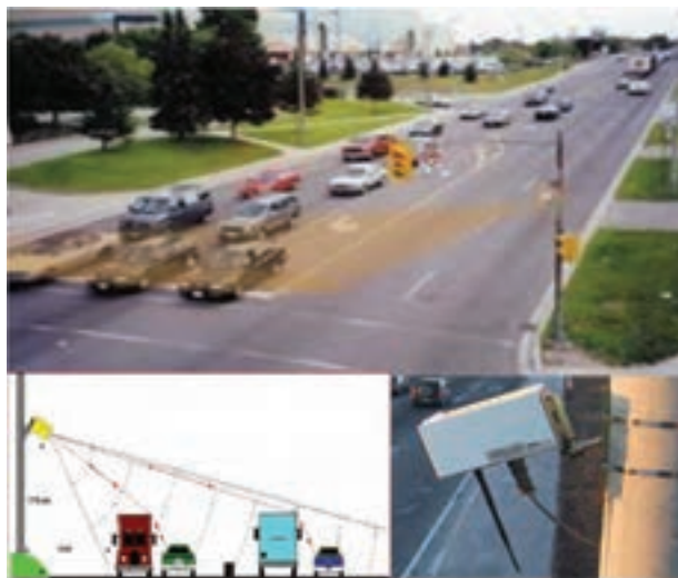
شکل ۴- رادارهای ماکروویو، نحوه نصب و چگونگی کارکرد آنها
