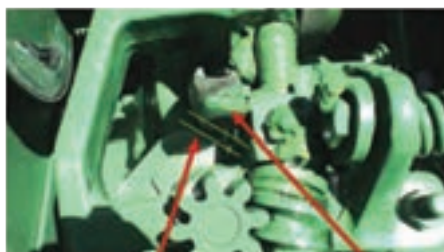
فاصله 1/5 تا 3\text{mm} سوزن
