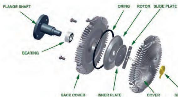
در دمای سرد: بی‌متال جمع شده و در نتیجه مایع سیلیکون مخصوص در محفظه مخزن مانند باقی می‌ماند. در این مرحله، اتصال دو قسمت فن قطع می‌شود و در حدود ۲۰٪ سرعت چرخش موتور چرخش می‌یابد.
