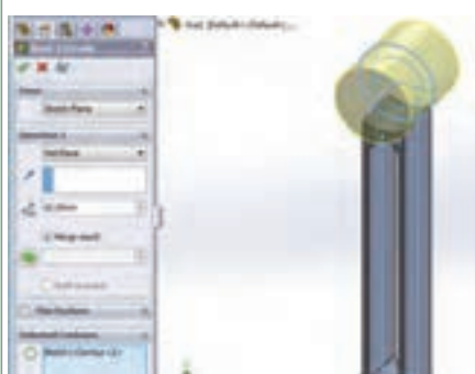
۲- حجم قطعه به روش Mid Plane و به مقدار ۴۲ میلی‌متر
