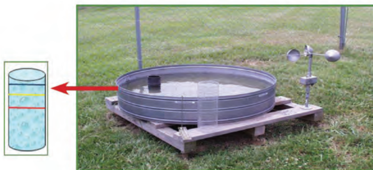
تشت تبخیر و اجزای آن (تشت، استوانه کوچک درون تشت و پیمانہ)
