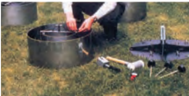
شکل ۳۰-۱ نحوه کار گذاشتن استوانه مضاعف
