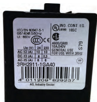
شکل ۱۷- برچسب یک کنتاکتور کمکی
