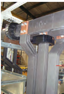
شکل ۲۱- شینه دو تایی و سه تایی ورودی و خروجی کلید هوایی
