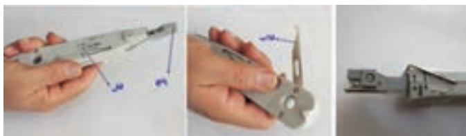
شکل ۳- اجزای مختلف دستگاه پنچ زن
