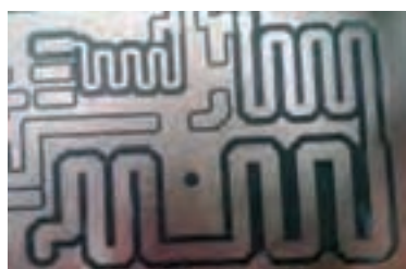
(چ) فیبر آماده شده را شست و شو دهید شکل ۹۰- مراحل ساخت فیبر مدار چاپی
