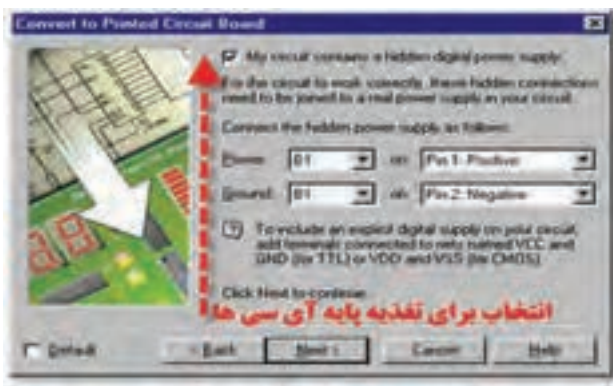
شکل ۱۰۳- پایه های +V و زمین آی‌سی‌ها در طرح مدار چاپی
