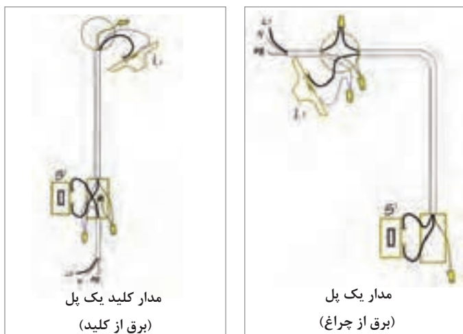
شکل ۴۴- نحوه اتصال کلید یک پل و لامپ
