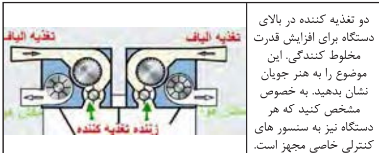
شکل ۱۸- تغذیه دوپل (دوغلطکی) برای مخلوط کردن بیشتر
