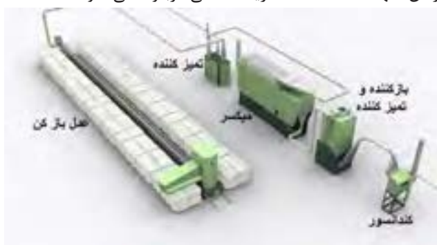
شکل ۱۰ - یک نمونه از خط حلاجی اتوماتیک
