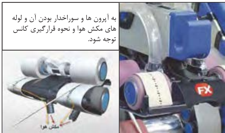
شکل ۲۸- سیستم کامپکت به روش زینسر
