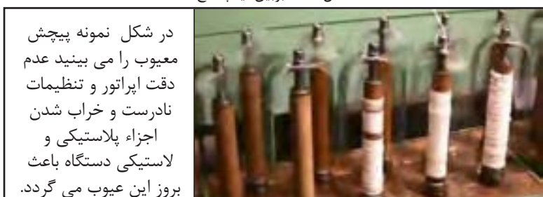
شکل ۱۷ پیچش معیوب نیمچه نخ
