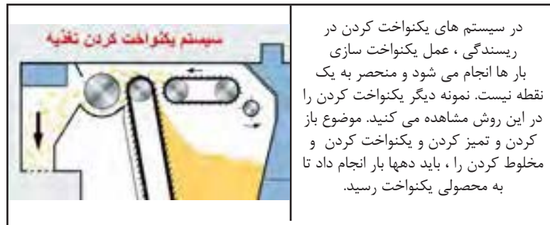
شکل ۲۰- برای داشتن محصولی یکنواخت ابتدا باید تغذیه ای یکنواخت داشت.
