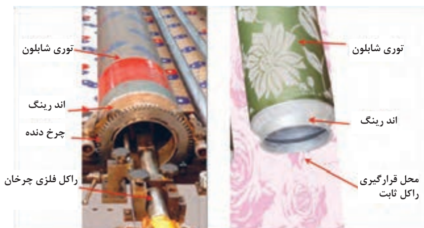
شکل ۶- اندرینگ ساده و چرخ دنده متصل به اندرینگ
