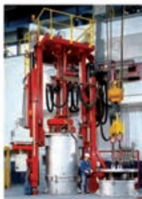
شمای کوره ذوب مجدد قوسی در خلأ و تصویر واقعی
