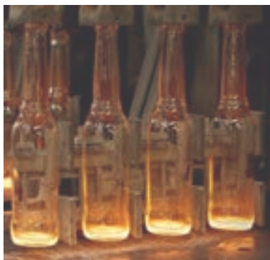
ب) شکل دهی به روش دستگاهی
