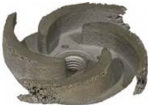
۲-۳ آسیب دیدگی پروانه پمپ در اثر پدیده کاویتاسیون
