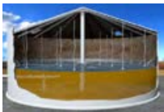
مخازن سقف شناور درونی
