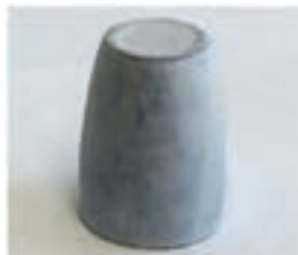
قالب فلزی مورد استفاده در روش دراپینگ
