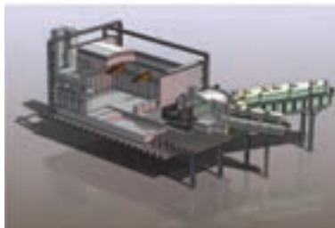
کوره با کانال تنظیم گرانیروی (فورهارت)
