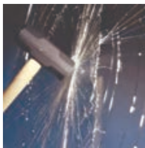
شکسته شدن شیشه تنش‌زدایی شده در اثر ضربه
