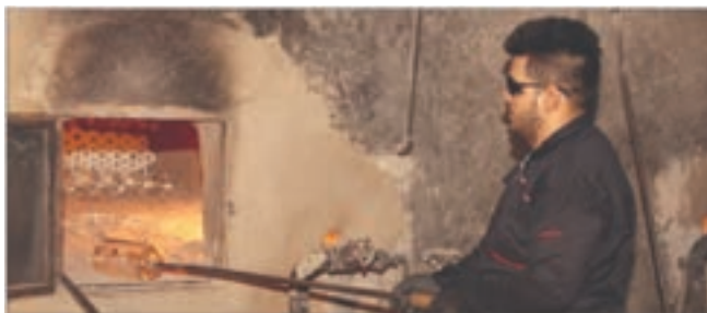
قرارگیری شیشه در گرمخانه
