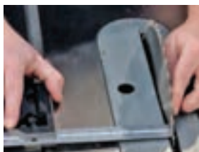
تنظیم تیغه بعد از خاموش شدن دستگاه
