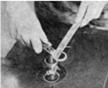
شافت فرز با متعلقات و روش بستن آن
