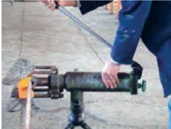
شکل ۳- قرار دادن لوله در خمکن و خم کردن لوله
