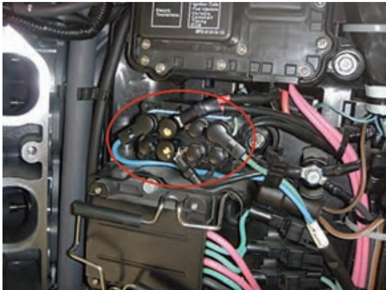
رله‌های سیستم جک
