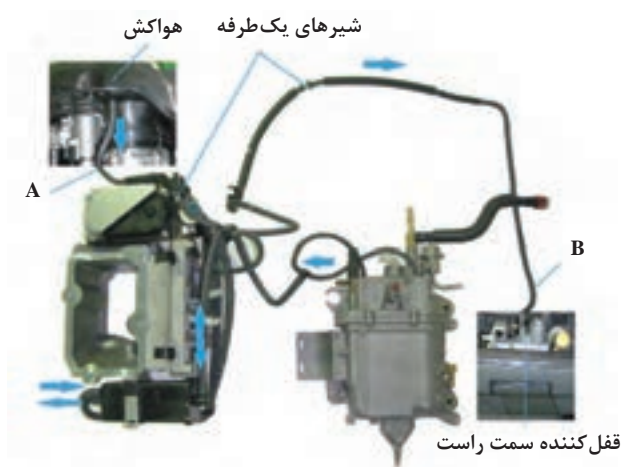
مسیر بخارات سوخت در موتور ۲۵۰
