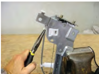
تنظیم قرقره و بست های تسمه
