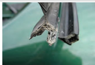
بررسی خرابی لاستیک آب‌بندی کنار شیشه
