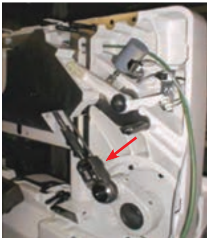
پیچ ایمنی / پیچ فیوز در محور اتصال بازوی مکانیکی برش
