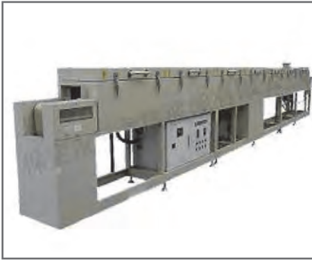
کوره خشک کن چوب با سیستم مایکروویو
