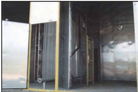
کوره خشک کن چوب با پروانه رادیال به قطر ۴ متر
