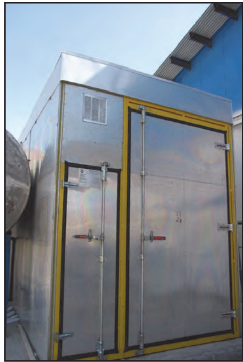
کوره خشک کن چوب با پروانه به قطر ۳ متر
