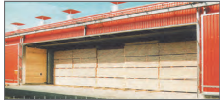
کوره خشک کن چوب با سیستم گردش هوای گرم از بالا به پایین
