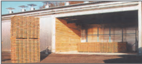
کوره خشک کن چوب با سیستم گردش هوای گرم از بالا به پایین
