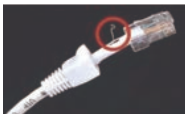
کابل شبکه به همراه میکروفن جاسازی شده
