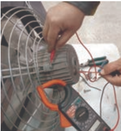
اندازه‌گیری مقاومت اهمی موتور یونیت هیتر
