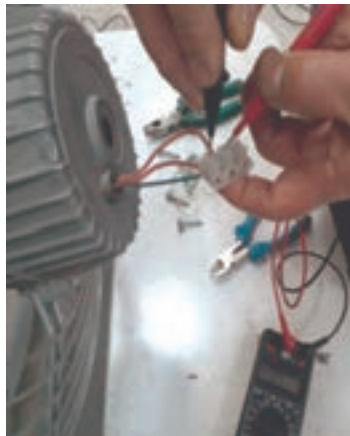
اندازه‌گیری مقاومت اهمی موتور یونیت هیتر
