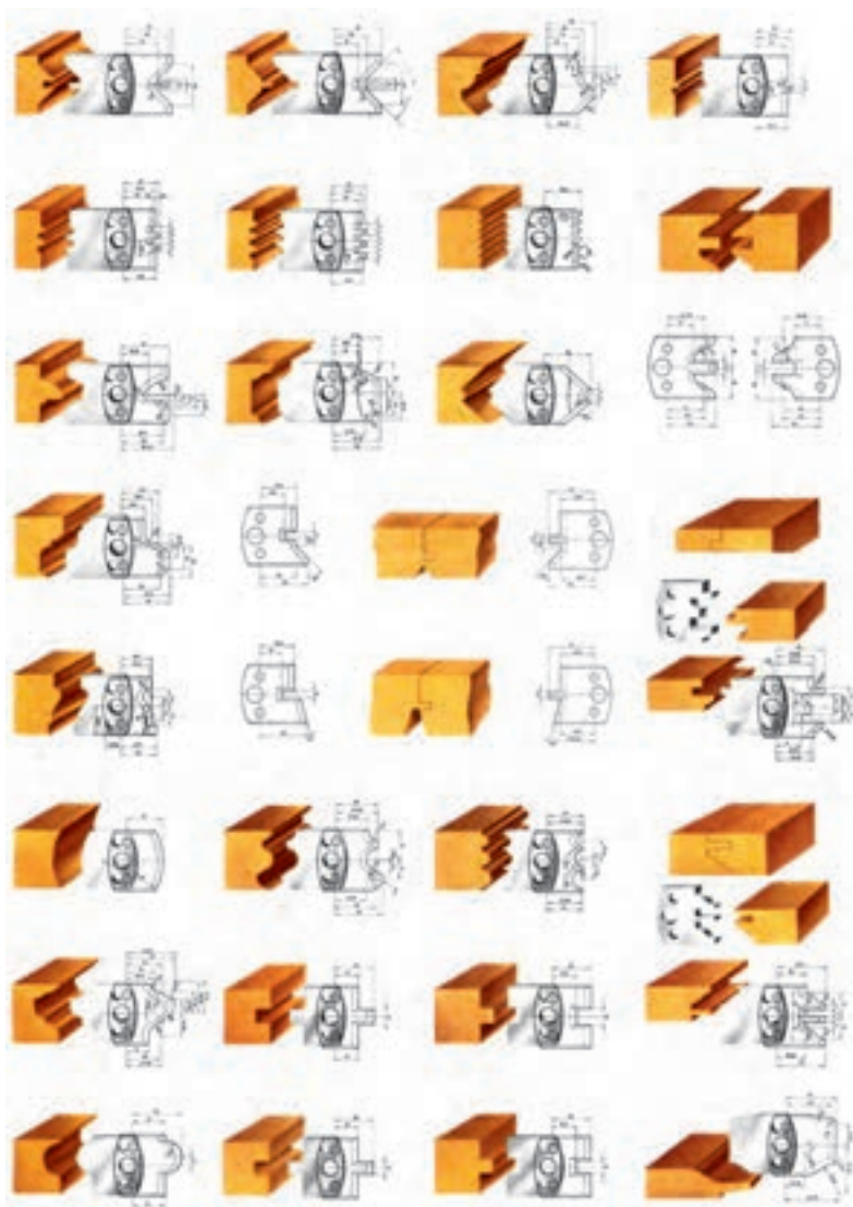
تیغه‌های متعددی که جهت پروفیل‌های مختلف به کار می‌رود نشان داده شده است. در ضمن ابعاد و اندازه‌های هر پروفیل در نمونه‌ها مشاهده می‌گردد.
