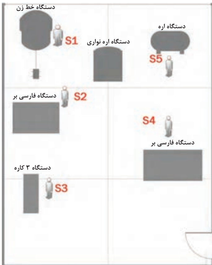
نقاط اندازه‌گیری شده مواجهه فردی صدا در واحد نجاری شرکت تولیدی صنایع چوب
