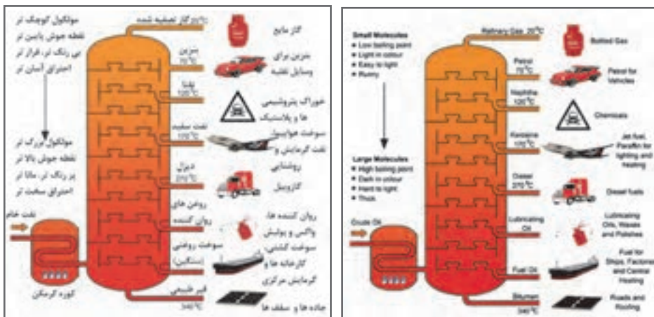
برش‌های مختلف نفت خام در برج تقطیر
