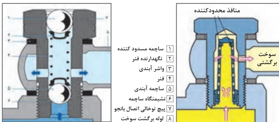
اجزای یک نمونه سوپاپ سر ریز در سیستم دیزل
