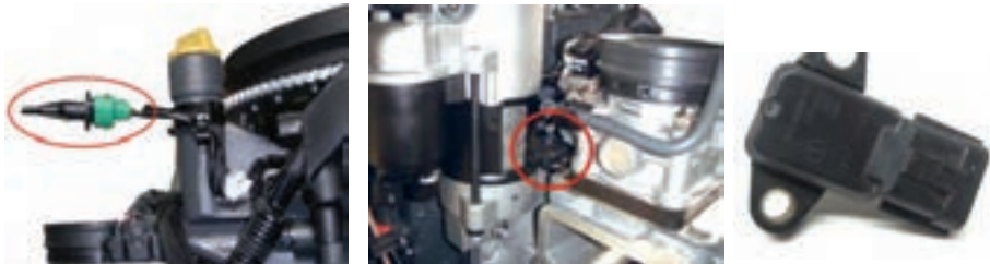
حسگر فشار هوا و دمای هوای ورودی موتور ۲۵۰ شکل ۲۰ دمای هوای ورودی موتور ۲۵۰
