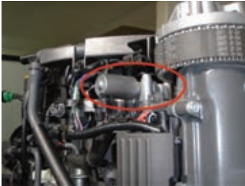
شیر کنترل روغن سیستم میل بادامک ورودی متغیر موتور ۲۵۰
