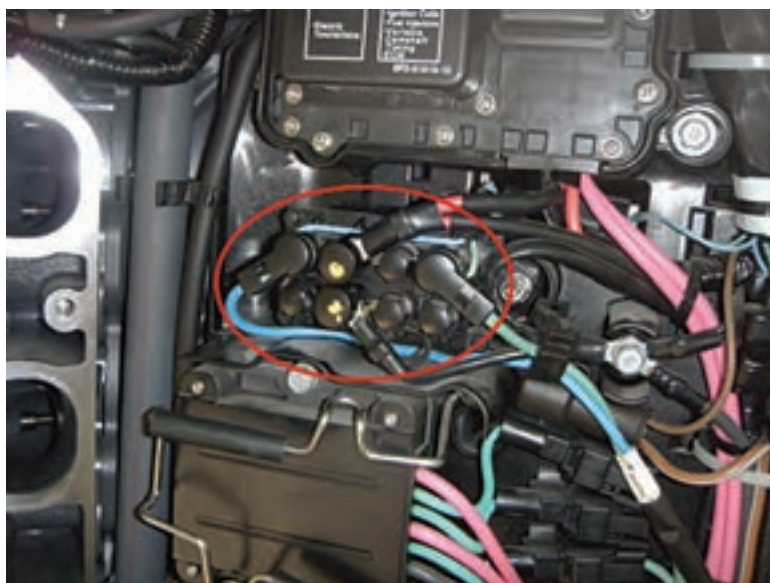
رله‌های سیستم جک
