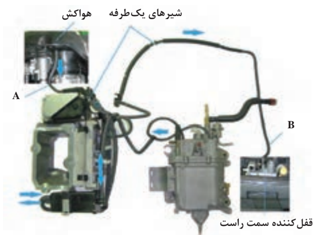
مسیر بخارات سوخت در موتور ۲۵۰
