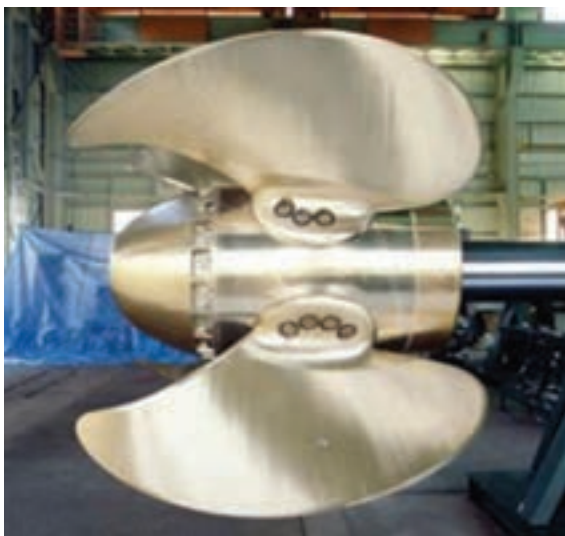
تصویری از حالت feathering در پروانه ها
