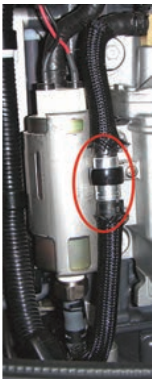
پمپ فشار پایین به همراه شیر یک‌طرفه
