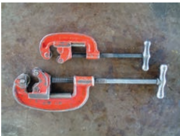
شکل ۱-۶۳- لوله‌بر در دو اندازه‌ی متفاوت
