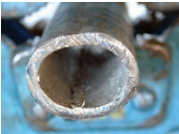
شکل ۱-۶۱- لوله‌ی دو پهن شده
