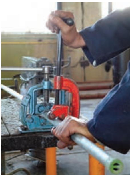
شکل ۱-۵۸ - ادامه‌ی عمل بُرش کاری
