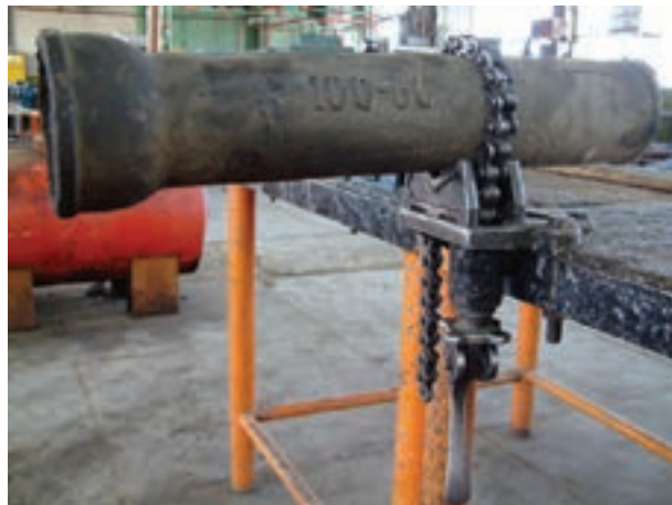
شکل ۱-۳۴- بستن لوله به گیره‌ی زنجیری
