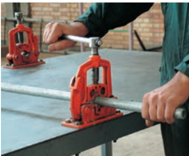
شکل ۱-۲۸- بستن لوله به گیره‌ی لوله
