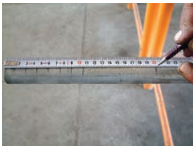
شکل ۱-۶۴-۱ خط کشی کردن لوله
