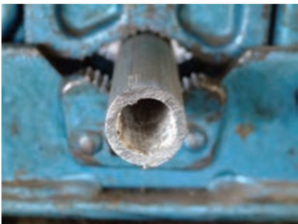
شکل ۱-۵۲ - لوله‌ی بسته شده به گیره‌ی لوله
