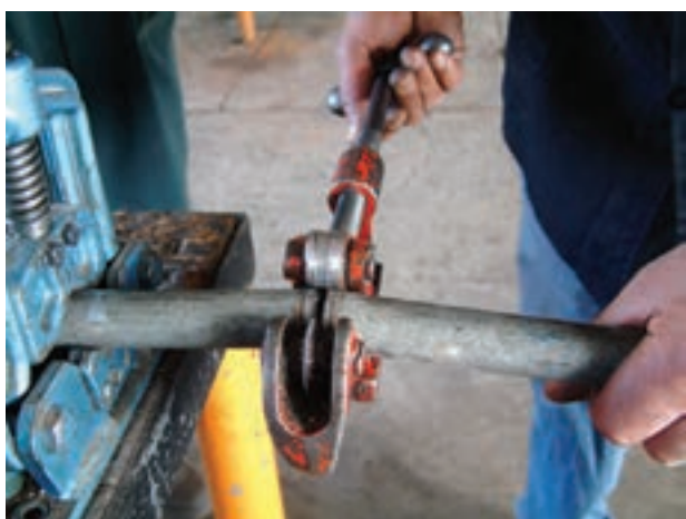
شکل ۱-۵۹ - انتهای عمل بُرش کاری
