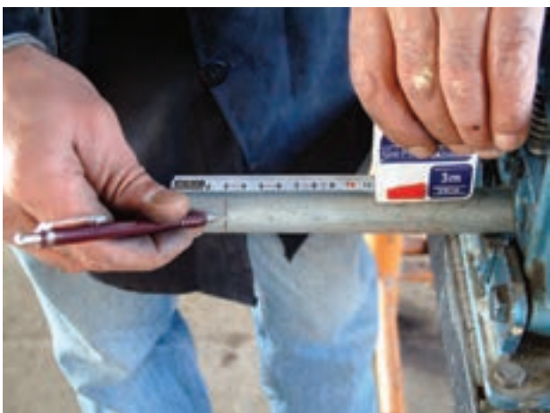
شکل ۱-۵۳ - مشخص کردن محل برش
