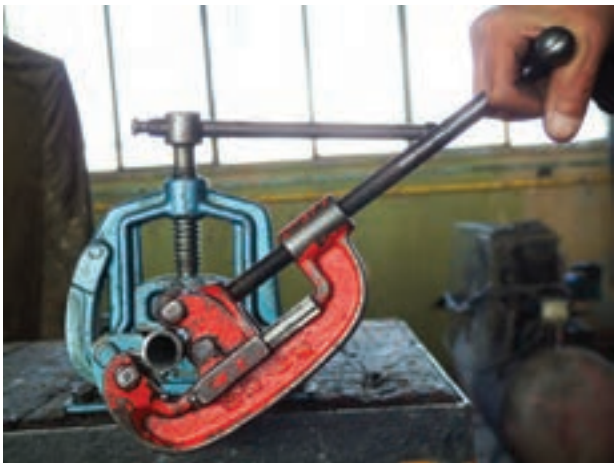
شکل ۱-۵۶- گرداندن لوله‌بر به دور لوله
