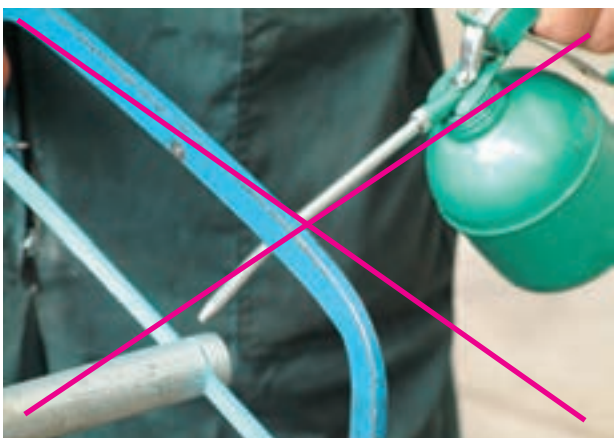
شکل ۱-۴۲ - هیچ‌گاه از روغن در اژه‌کاری استفاده نکنید.
