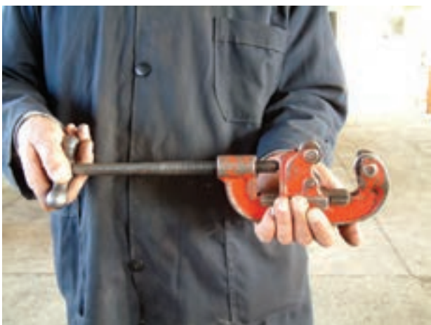
شکل ۱-۵۴ - باز کردن دهانه‌ی لوله‌بر
