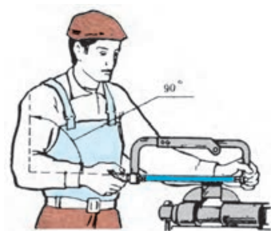
الف - ااره‌کاری به وسیله‌ی کمان ااره
