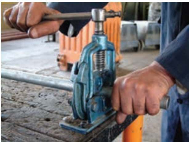
شکل ۱-۳۵ - بستن لوله به گیره برای ارّه کاری
