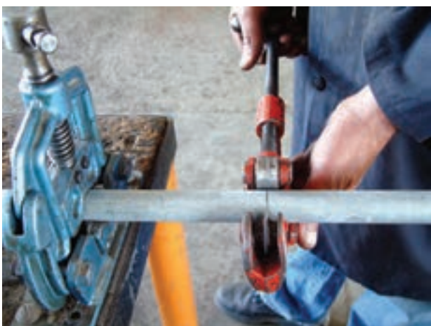
شکل ۱-۶۲- سفت کردن دسته‌ی لوله‌بر به اندازه‌ی لازم
