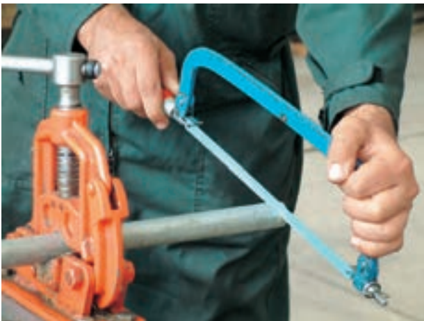
شکل ۵۰-۱- عدم رعایت فاصله‌ی مناسب از لب گیره
