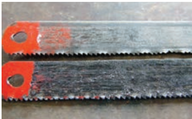
شکل ۱-۴۷- تیغه اره‌های دندان‌های شکسته شده
