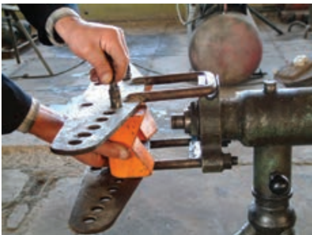
شکل ۳-۱۸- طرز قرار دادن لقمه ها در صفحه ی راهنمای خم کن
