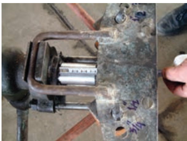
شکل ۳-۲۷- اندازه‌گیری طول بیستون خارج شده از سیلندر
