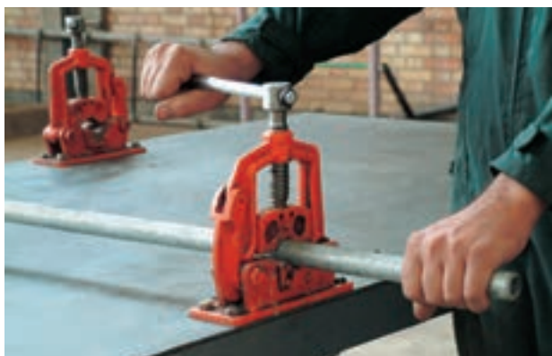
شکل ۳-۵۳- باز کردن شاخه‌ی لوله از گیره‌ی لوله
