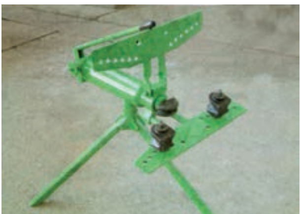
شکل ۳-۴۸- قرار گرفتن لقمه در محل مناسب خود
