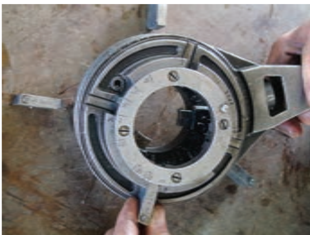
شکل ۴-۵۹- خارج کردن پارچه‌ها از حدیده
