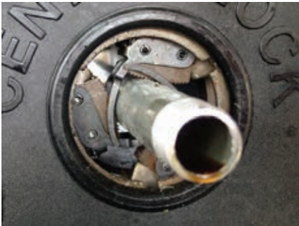
شکل ۴-۷۳- سه نظام ثانویه حدیده‌ی ماشینی
