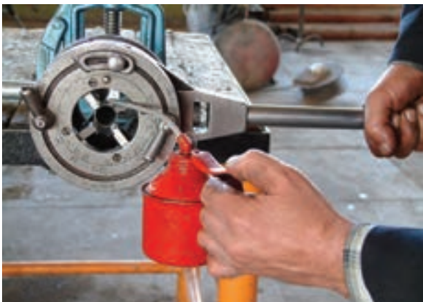
شکل ۴-۶۸- عمل روغن کاری در حین حدیده کاری
