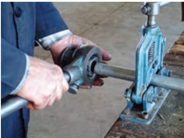
شکل ۴-۴۵- شروع حدیده کاری
