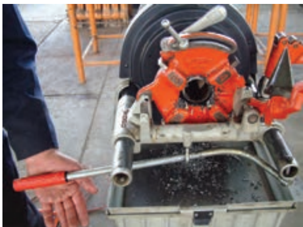
شکل ۴-۹۸- کشیدن اهرم به عقب پس از حدیده‌کاری
