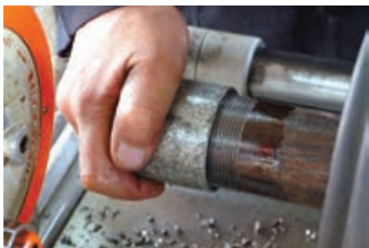
شکل ۴-۱۰۰- امتحان کردن بار دنده به وسیله‌ی یک فیتینگ
