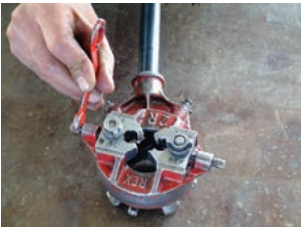
شکل ۴-۲۹- تنظیم کردن حدیده به وسیله‌ی آچار حدیده
