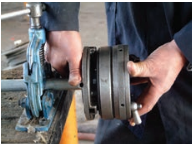
شکل ۴-۷۱- باز کردن سه نظام حدیده
