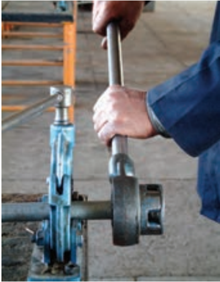
شکل ۴-۴۸- عمل حدیده کاری
