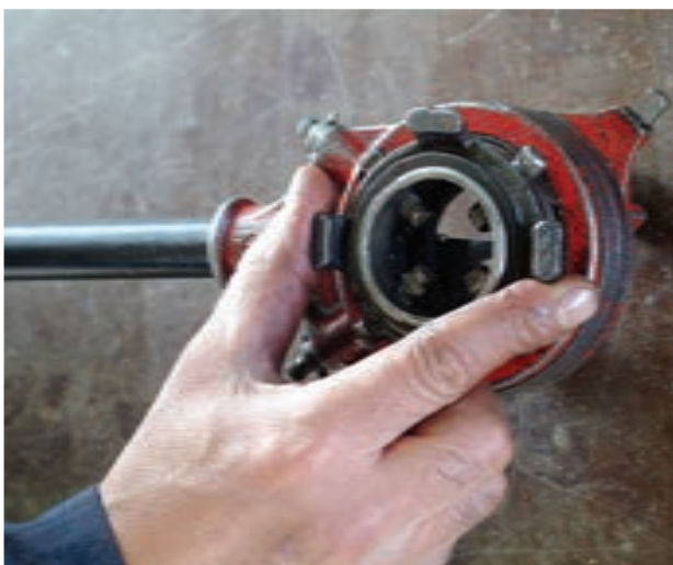
شکل ۴-۲۱- فلکه‌ی چهار نظام حدیده‌ی دستی دو پارچه
