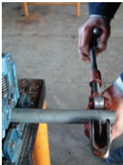
شکل ۴-۷۷- لوله‌بر در حال گردش به دور لوله
