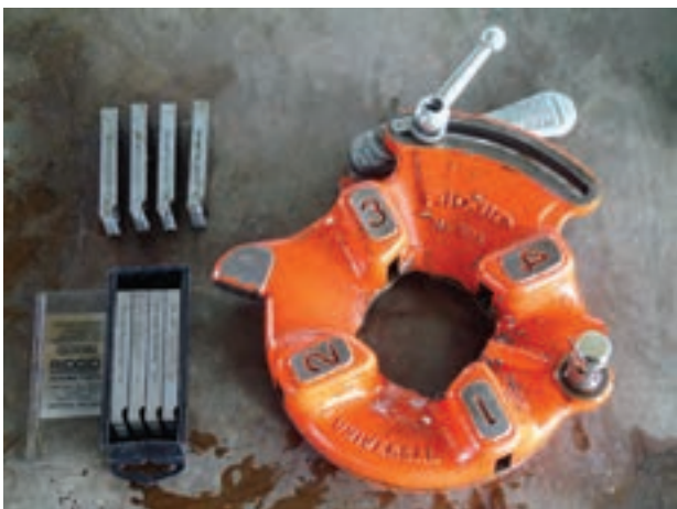
شکل ۸۸-۴- تنه‌ی حدیده و پارچه‌های آن
