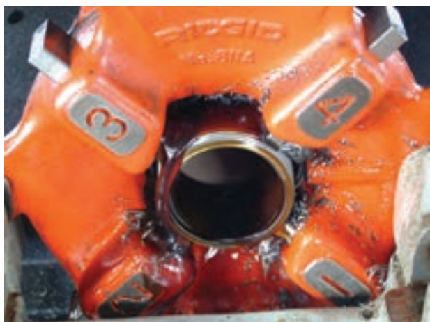
شکل ۴-۸۲- استفاده از روغن در موقع حدیده‌کاری
