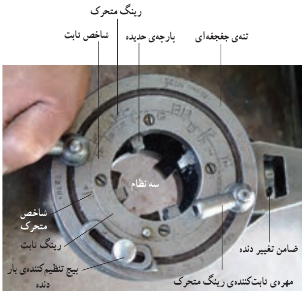
شکل ۴-۵۵- اجزای حدیده‌ی دستی چهار پارچه
