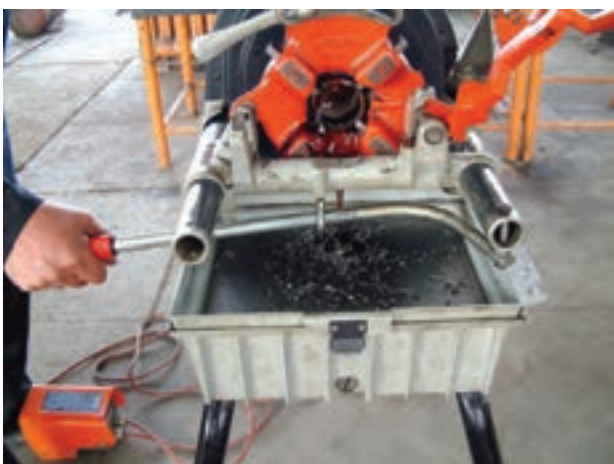
شکل ۸۵-۴- پلیسه‌های ریخته شده بر روی صفحه‌ی مشبک حاصل از عمل حدیده‌کاری
