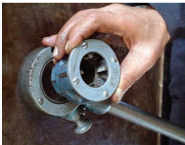
شکل ۴-۴۴- خارج کردن پارچه از بدنه‌ی حدیده
