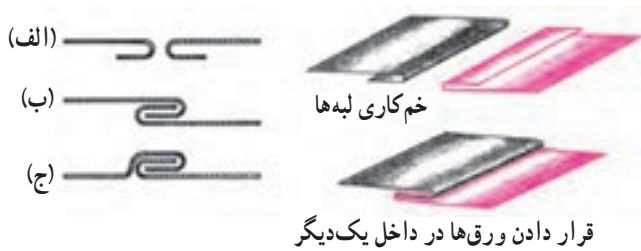
شکل ۴-۲- مراحل مختلف اتصال پیچک
