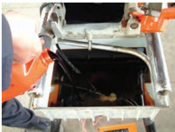
شکل ۴-۸۳- مخزن روغن حدیده‌ی ماشینی
