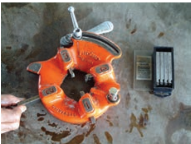
شکل ۴-۹۲- جا زدن پارچه‌ها در شیارهای تنه‌ی حدیده
