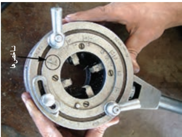
شکل ۴-۵۸- گرداندن رینگ متحرک و قرار دادن شاخص‌های A در یک راستا
