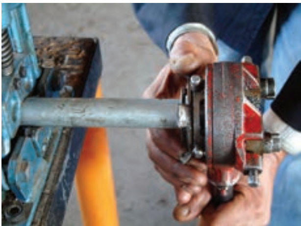
شکل ۴-۳۹- باز کردن فلکهای چهارنظام
