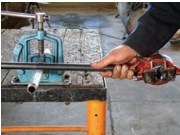
شکل ۴-۴۰- جدا کردن پلیسه‌ها از سردنده
