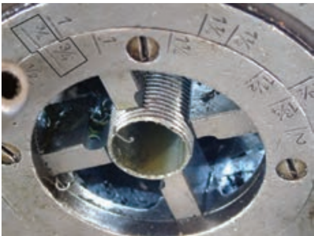
شکل ۴-۶۹- حد صحیح حدیدیه کردن لوله \frac{3}{4} "
