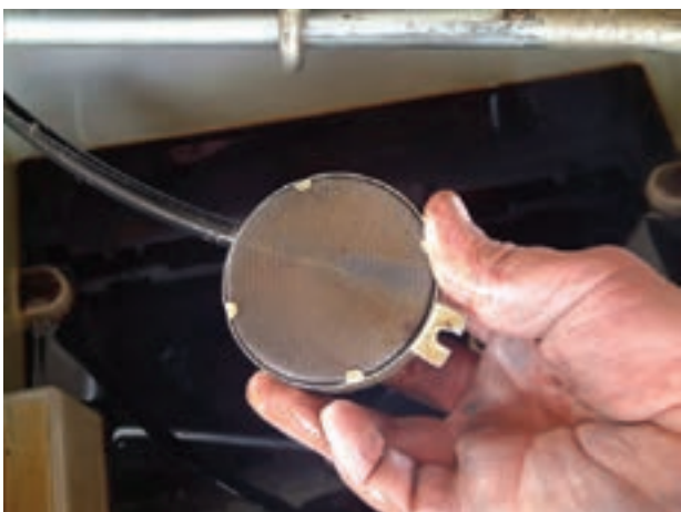
شکل ۸۴-۴- پمپ روغن حدیده‌ی ماشینی
