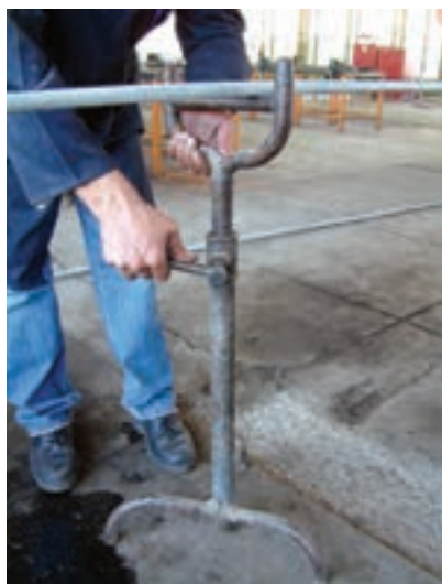
شکل ۴-۷۶- طرز تنظیم خرک به زیر لوله
