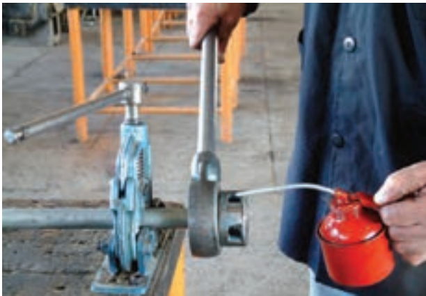
شکل ۴-۴۹- روغن کاری محل تماس پارچه‌ها با لوله
