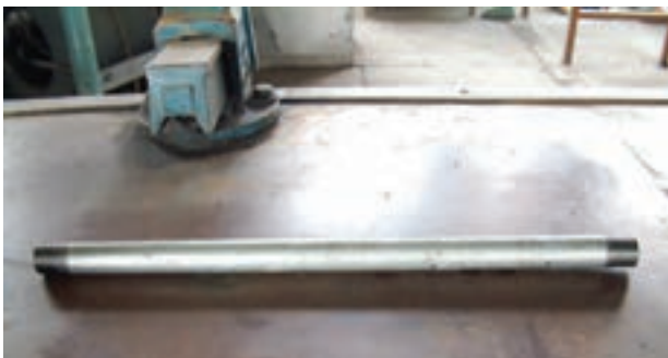
شکل ۴-۶- لوله‌ی دو سر دنده شده
