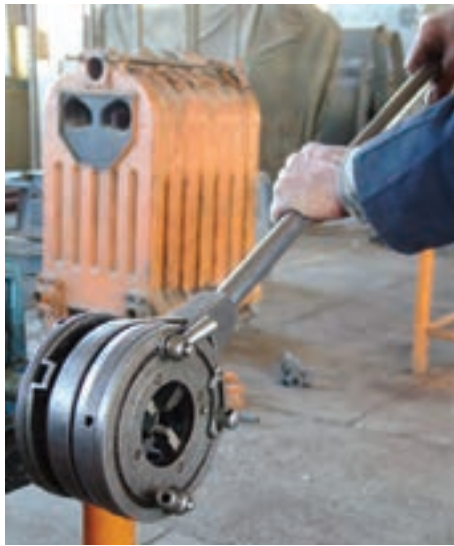
شکل ۴-۶۷- دنده کردن لوله
