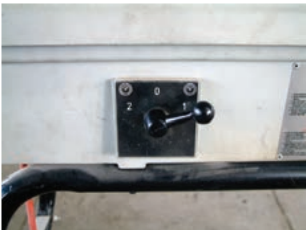
شکل ۴-۷۹- کلید خاموش و روشن کردن حدیده‌ی ماشینی
