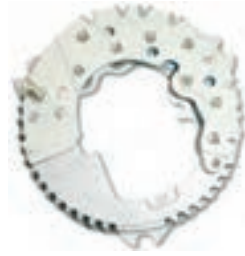
دیودهای مورد استفاده در آلترناتور خودرو
