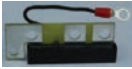
دیودهای مورد استفاده در آلترناتور خودرو
