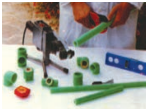
شکل ۵-۲۷ - بریدن لوله به وسیله‌ی قیچی مخصوص
