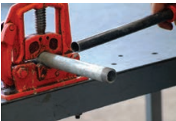
شکل ۴-۱۱۷- جداسازی پلیسه از سر دنده
