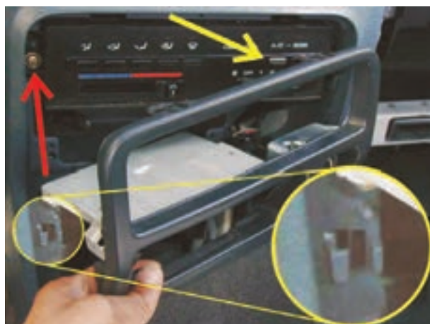
شکل ۳۸-۵ باز کردن قاب سوئیچ‌ها
