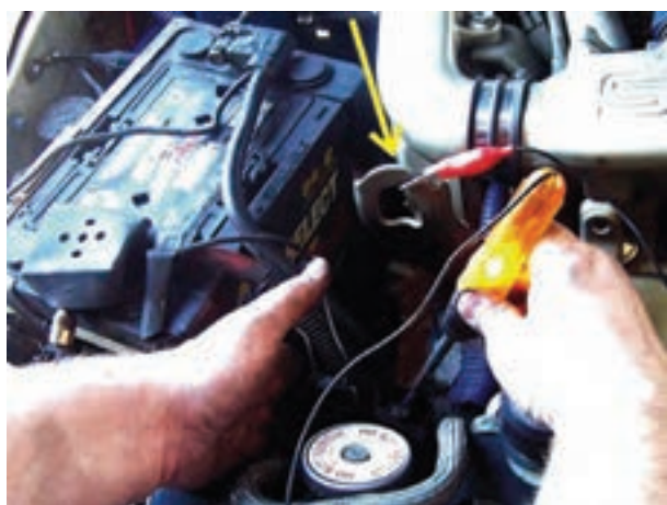
شکل ۴۳-۵ نحوه ی آزمایش سالم بودن سیم کشی
