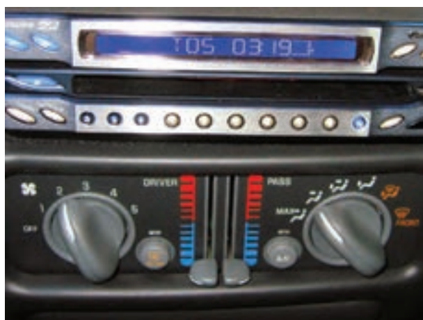
شکل ۵-۲۳ سوئیچ راه‌انداز فن کولر
