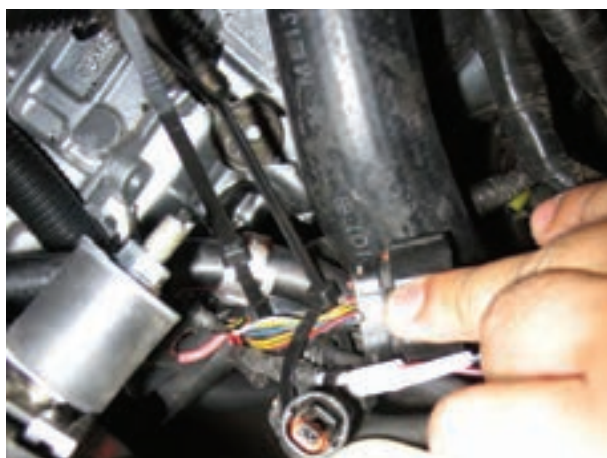
شکل ۴۵-۵ بررسی اتصالات الکتریکی سیم‌کشی
