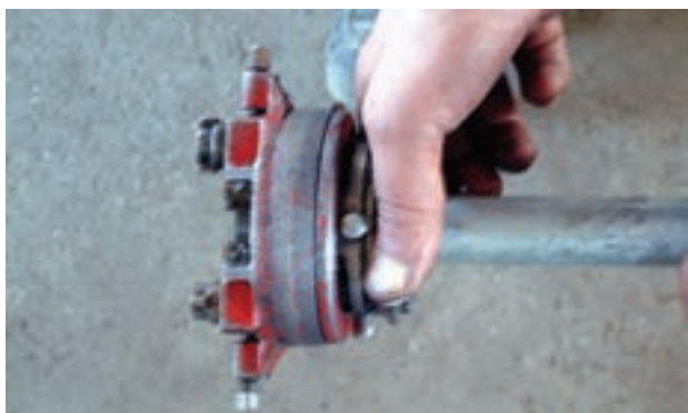
شکل ۱۲۴-۵- باز کردن فلکهای چهار نظام حدیده
