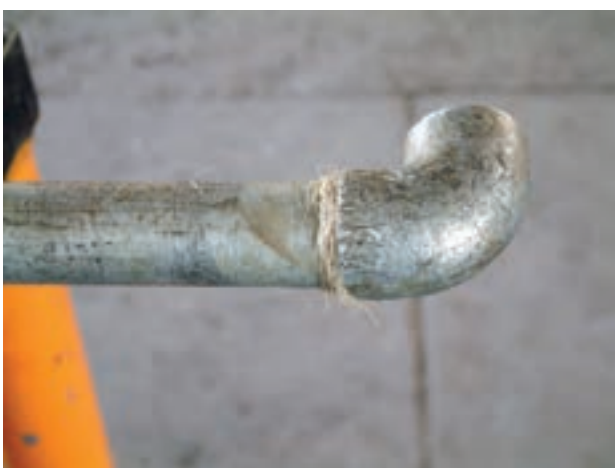
شکل ۹۸-۵- فیتینگ بدون لبه
