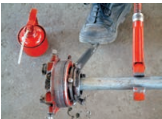
شکل ۱۲۳-۵- عمل باز کردن سردنده از پارچه‌های حدیده
