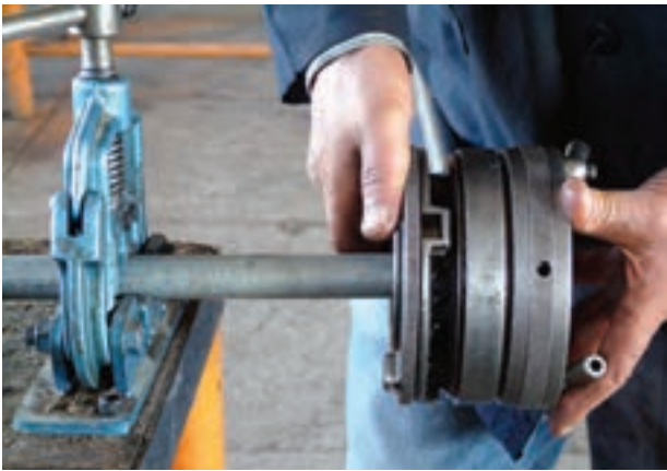
شکل ۱۳۰-۵- حدیده کردن لوله‌ها
