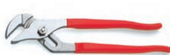
شکل ۷۱-۵- انبر کلاغی شیاردار
