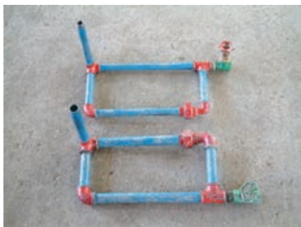
شکل ۵-۱۱۰- مدار بسته لوله‌کشی
