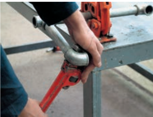
شکل ۱۰۵-۵- روش غلط سفت کردن مدار
