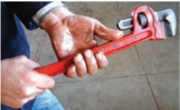
شکل ۱۰۱-۵- اقدام به کار با دست‌های چرب و روغنی
