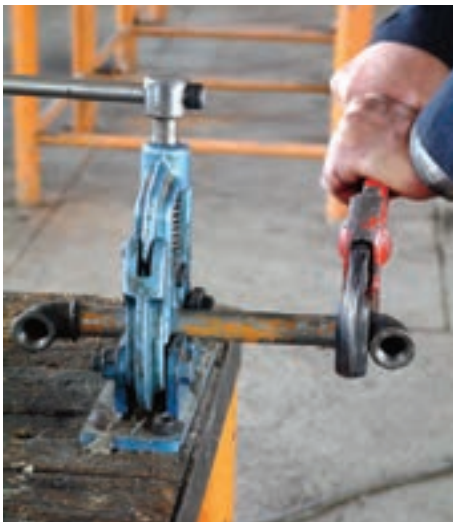
شکل ۱۳۲-۵- سفت کردن فیتینگ‌ها به لوله‌ها و تکمیل مدار باز
