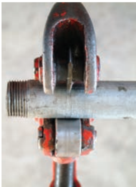
شکل ۹۶-۵- استفاده‌ی غلط از لوله‌بُر با تیغهی شکسته
