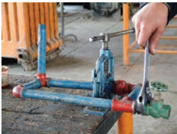
شکل ۱۶۳-۵- بستن شیر فلکه به سده‌راهی ۹۰ درجه و تکمیل نمودن مدار
