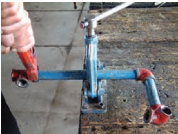
شکل ۵-۱۵۵- بستن سه‌راهی به ضلع دوم مدار
