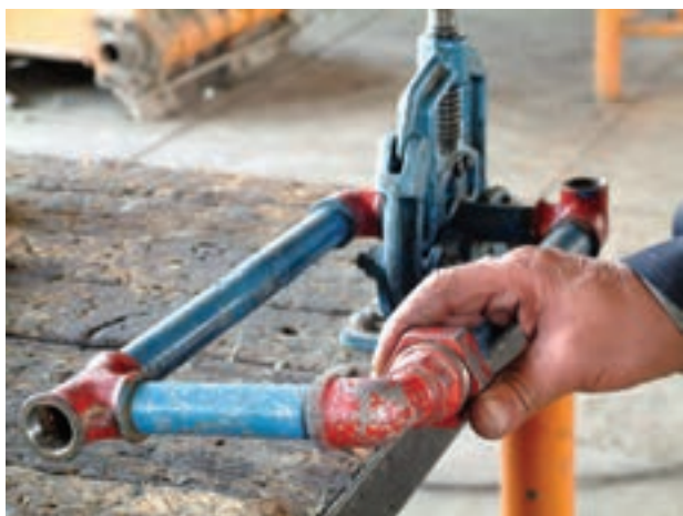
شکل ۱۶۰-۵- بستن مهره ماسوره به وسیله ی دست
