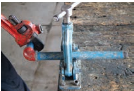
شکل ۱۵۴-۵- بستن لوله‌ی ضلع دوم مدار
