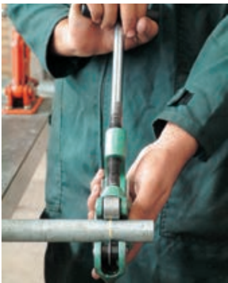
شکل ۱۳۵-۵- بریدن لوله‌های مورد نیاز
