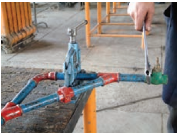
شکل ۱۴۶-۵- بستن شیر فلکه در محل خود و تکمیل نمودن مدار
