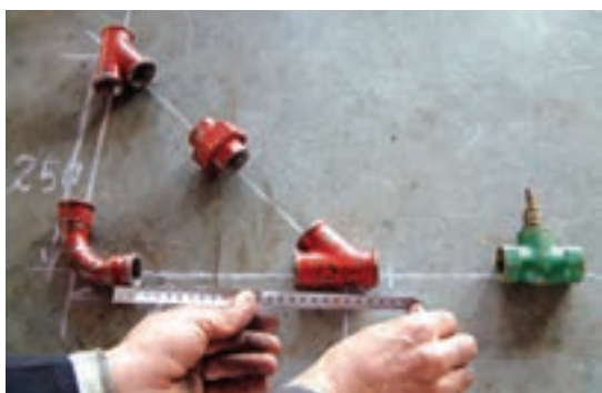
شکل ۱۳۴-۵- اندازه‌گیری لوله‌های مورد نیاز
