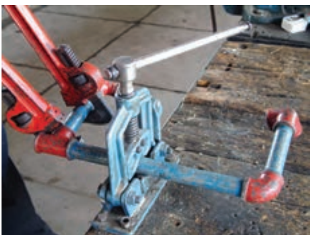
شکل ۵-۱۵۶- بستن ضلع سوم مدار به سه‌راهی
