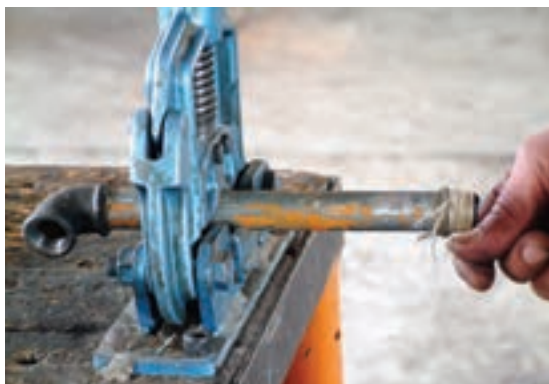
شکل ۱۵۳-۵- خمیر و کنف کردن سردنده‌ی بعدی
