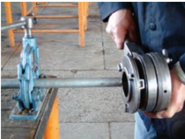
شکل ۱۳۶-۵- حدیده کردن لوله‌ها
