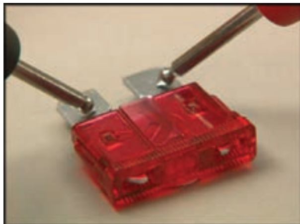
شکل ۱-۴۴ آزمایش فیوز توسط اهم‌متر
