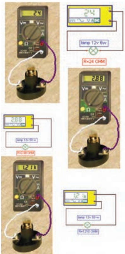
شکل ۸۹-۲- اندازه گیری مقاومت لامپ‌های روشنایی
