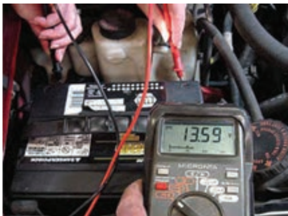
شکل ۵۰-۱ اندازه‌گیری ولتاژ با ولت‌متر دیجیتال
