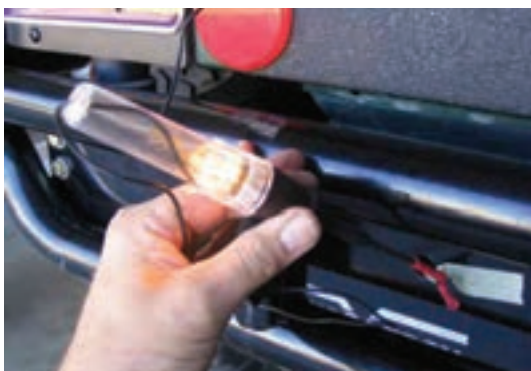
شکل ۲-۸۶ - استفاده از تستر لامپی
